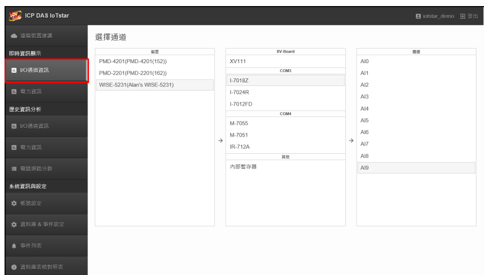
圖7-1: 即時資訊顯示—I/O 通道列表頁面
